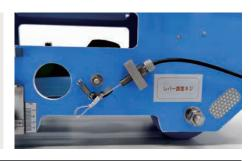
操作レバーにロック機構があり、研磨仕上りが均一です。 ロックする高さの微調整ができます。
